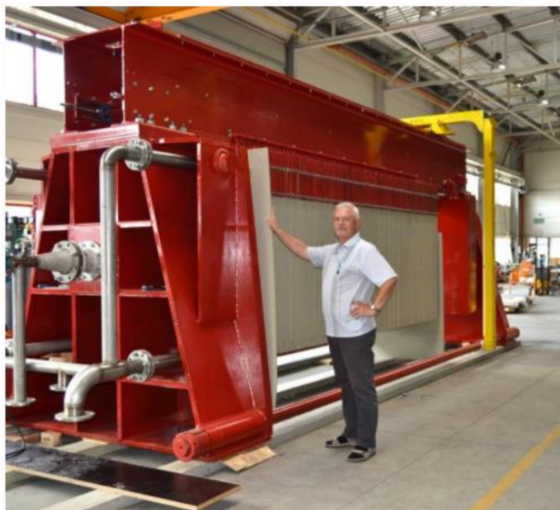
Figur 5.5: Kammer membran filter presse. Kilde: Ecoton.
